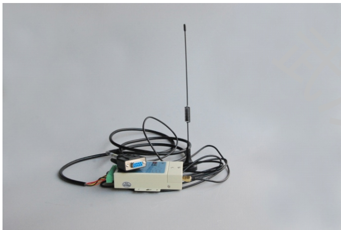
图 2-5 GPRS 无线上传模块示意图
