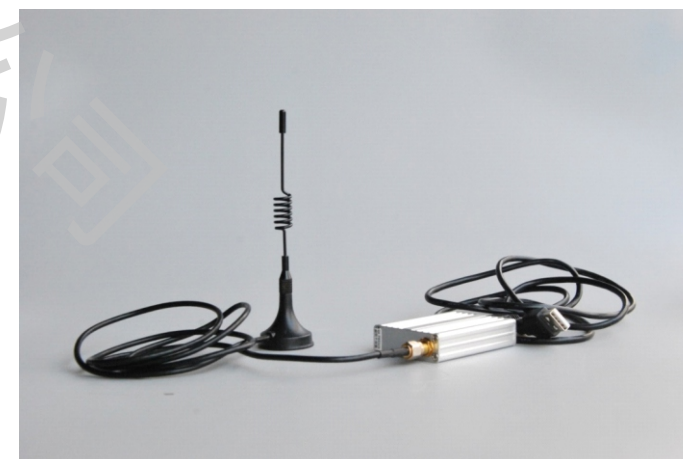
图 2-4 433 无线通讯模块示意图
