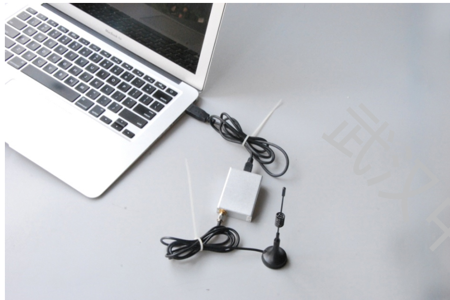
图 3-13 笔记本连接 433 模块示意图
